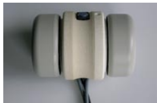
YoYo™: Interaktionsgerät zur Simulation räumlicher Interaktion mit mehr als sechs Freiheitsgraden
